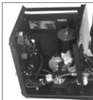
Fig. 18 Montage du faisceau de câbles de connexion de la DS II
